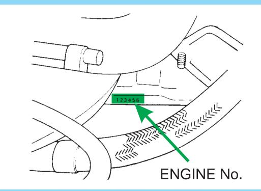
PETROL ENGINE No. STAMPED ON THE UPPER CENTER PART OF THE CYLINDER BODY
